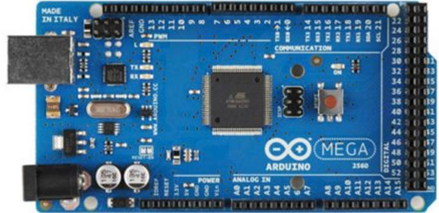
*Figure 10: Robo-Weeder Microcontroller.*
